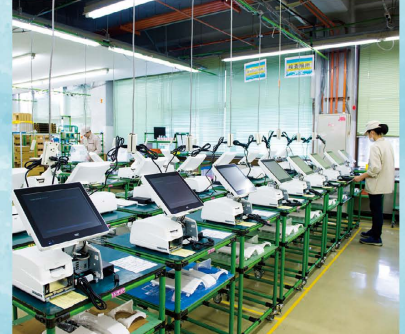
▲ずらりと並んでいるのは、新型POSTターミナルの「QT-200」。正確に作動するかどうか、通電検査を行ってから出荷される
