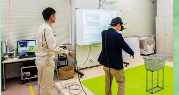
▲MR(Mixed Reality)技術を利用したシミュレーター。ゴーグルを着けるとカゴが置かれている位置にPOSレジの映像が映し出され、実際の導入イメージを確認できる
