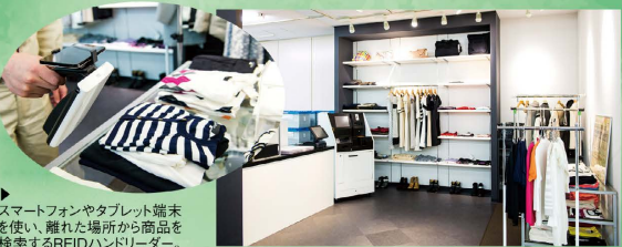
▲スマートフォンやタブレット端末を使い、離れた場所から商品を検査するRFIDハンドリーダー。毎日の入出荷作業や棚卸し業務に威力を発揮する
