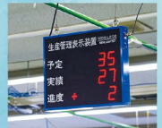
▲作業時間の目安として、1日の生産目標と実際の製造数が電光掲示板に表示される
