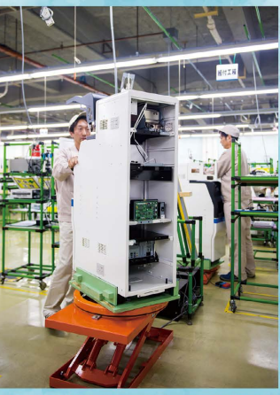
▲セミセルフレジのセットアップ作業。一人の作業者が1台ずつ担当し、丁寧かつスピーディーに仕上げている
