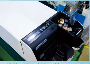
▲自動釣銭機は実際に使貨を入れて検査。77,970円入ると満タンの状態に。正確に作動するかどうかチェックする
