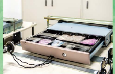
▲キャッシュドローの耐久試験。品質保証部では、製品の精度や耐久性などを調べる様々な試験が行われている
