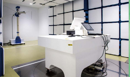
▶外部からの電磁波や無線通信などを遮断できる電波暗室。無線POSの性能やノイズの発生頻度などを調べるために使用される
