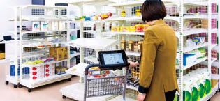
▲タブレット端末がカートに入れた商品を自動計算し、店舗を出るときに電子マネーなどから料金を引き落とすという近未来のチェックアウトシステムなども研究が進められている
