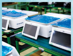
▲大仁サイトから出荷される製品のひとつが計量秤。秤は精度の違いによってわずかな誤差が生じるため、使用エリアに合わせて調整する
