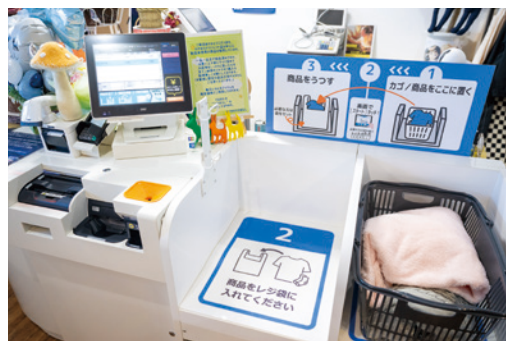
▲商品を読み取り台に置くだけで、瞬時に合計金額が表示される。バーコードをスキヤンする手間が省け、会計はスピーディー
