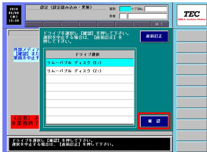
USB メモリが表示されていることを確認し、【確認】を押します。
