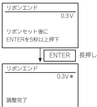
リボンエンドセンサーで検知したリボンの電圧を表示します。
