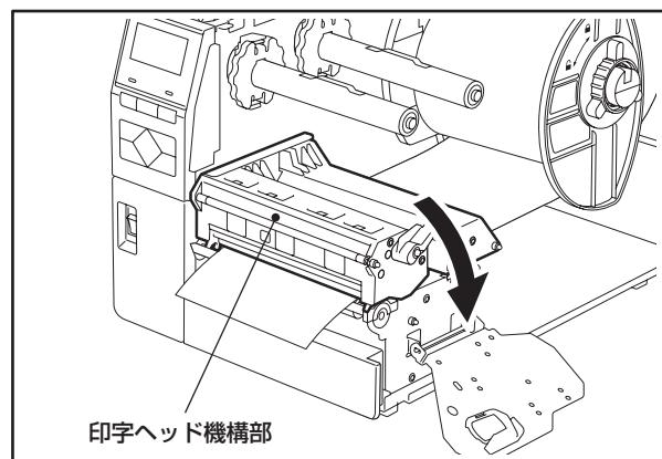
6 ヘッドブロック固定板をセットし、ヘッドレバーをPosition1位置に回し、印字ヘッド機構部を固定します。
