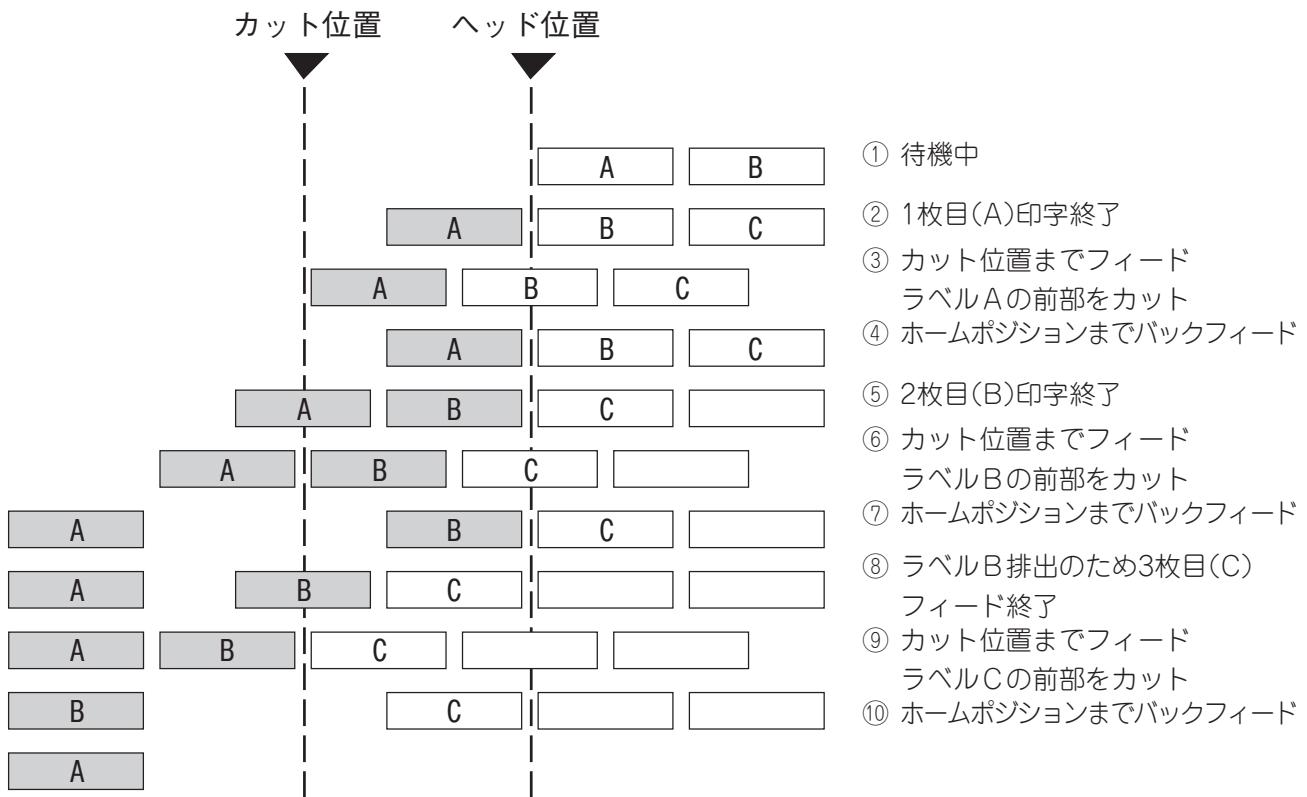
(26) バックフィード量微調  $-9.9\text{mm} \sim +9.9\text{mm}$  (0.1mm単位) (初期値:  $+0.0\text{mm}$ )
