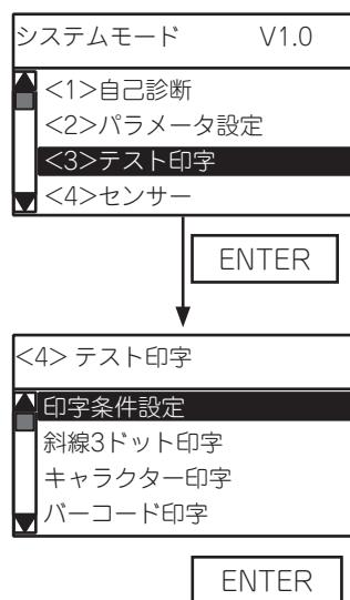
(1) システムモードのテスト印字メニューを選択します。
