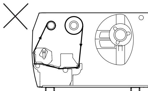
7 印字ヘッド機構部を下げる、ヘッドブロック固定板をセットします。
