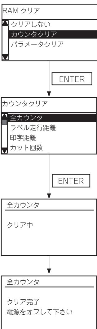
メンテナンスカウンタの各情報をクリアします。また、クリアする対象を「全カウンタ」、「ラベル走行距離」、「印字距離」、「カット回数」、「その他」から選択することができます。
