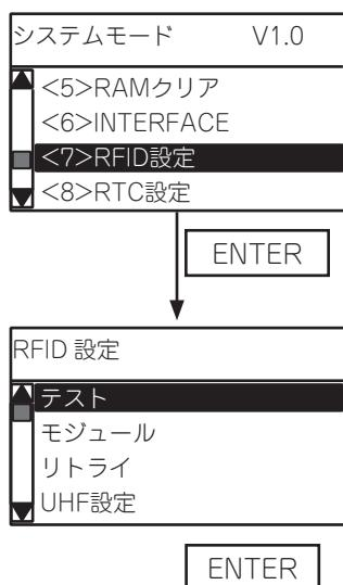
(1) システムモードのRFID設定メニューを選択します。
