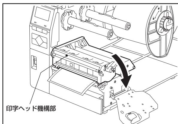
12 ヘッドロック固定板をセットし、ヘッドレバーをPosition1位置に回して印字ヘッド機構部を固定します。
