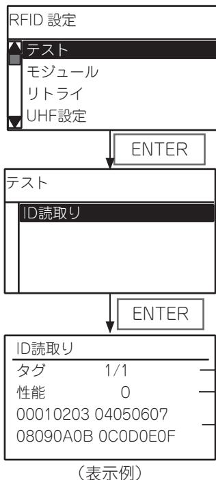
(1) RFIDタグをプリンタにセットして、「テスト」を選択します。
