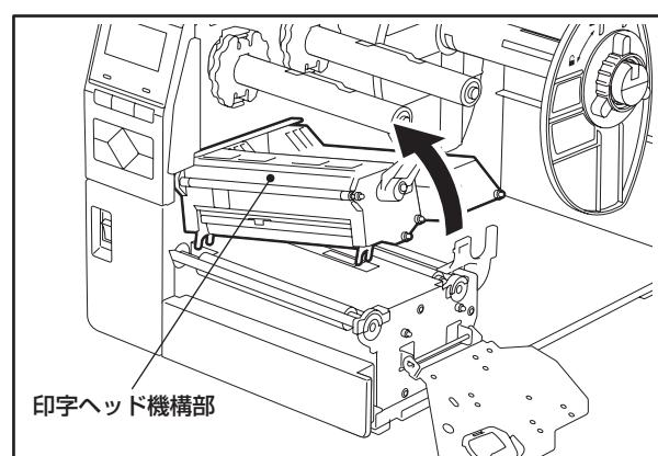
4 サプライ固定具を反時計方向へ半周ほど回して緩め、サプライ固定具をつけたままサプライホルダーを取り外します。
