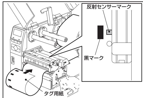
2 反射センサー位置マーク(■)の手前に黒マークが現れるところまで、右図のように用紙を後方へ送り込みます。
