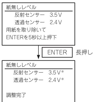
反射センサーと透過センサーで検知した紙無し(ペーパーエンド)状態の電圧を表示します。
