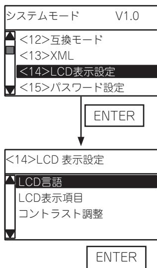
(1) システムモードのLCD表示設定メニューを選択します。
