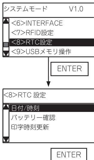
(1) システムモードのRTC設定メニューを選択します。
