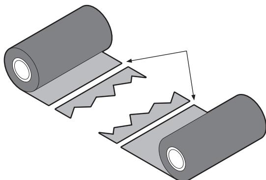
4 左右がずれないようにリボンを重ね合わせ、合わせ目をセロハンテープでしっかり留めます。
