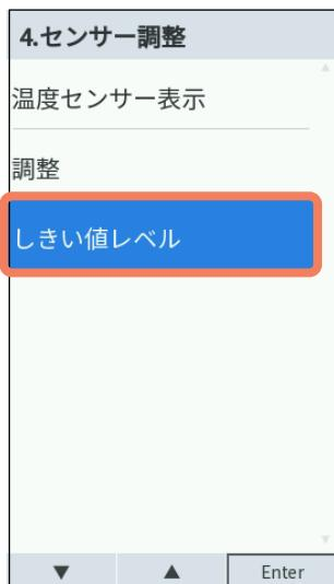
3 しきい値を微調整するセンサーを選択し、[PAUSE] キーを押します。
