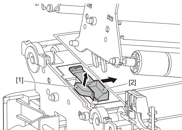
**13** ロックレバー [1] を押し下げて用紙幅検知ガイドをロックします。
