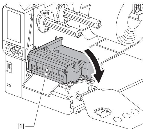
6 リボンシャフト固定板 [1] をセットし、ヘッドレバー [2] を「LABEL2」位置に回して印字ヘッド機構部を固定します。
