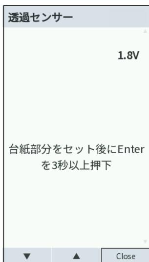
**4** ラベル紙からラベルをはがした台紙を透過センサーの上にセットします。
