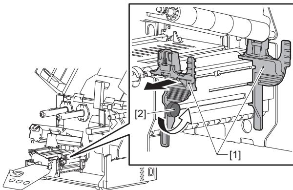
**9 用紙 [1] の先端を左右の用紙ガイド [2] の間へ通し、印字ヘッド機構部の下側を通して用紙発行口まで送り出します。**
