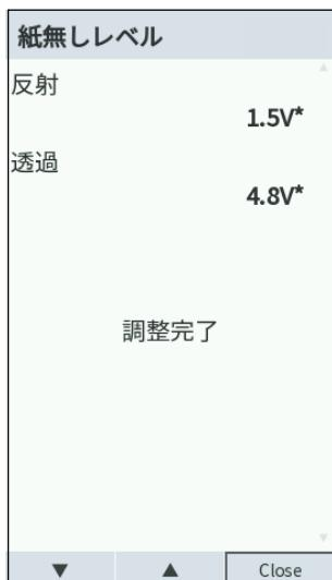
反射センサー設定範囲：0.0 V ~ 5.0 V
