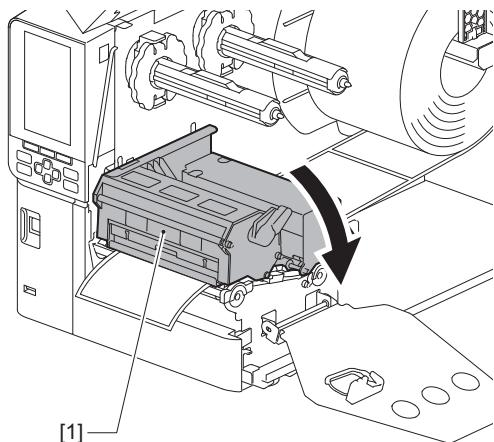
**15** リボンシャフト固定板 [1] をセットし、ヘッドレバー [2] を「LABEL2」位置に回して印字ヘッド機構部を固定します。
