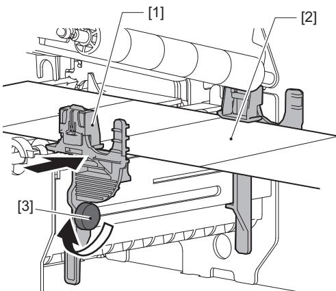
**11** ロックレバー [1] を持ち上げ、用紙幅検知ガイド [2] を動かして用紙の端に合わせます。
