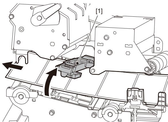
**11** 用紙ガイド [1] と用紙 [2] のすき間を0.5 mm程度に合わせ、化粧ネジ [3] を締めて固定します。
