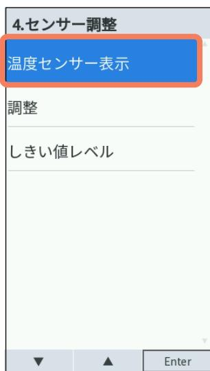
印字ヘッド温度と外気温度が表示されます。
