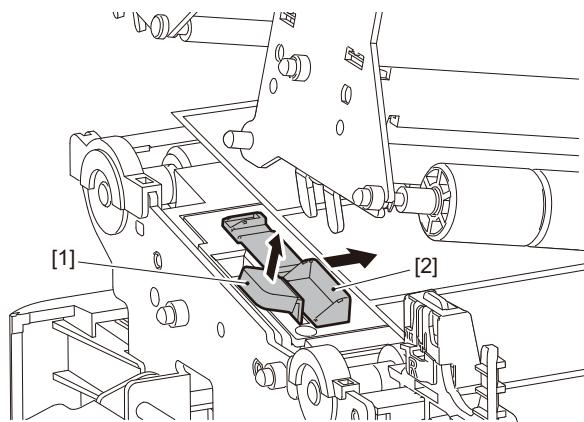
**12** ロックレバー [1] を押し下げて用紙幅検知ガイドをロックします。
