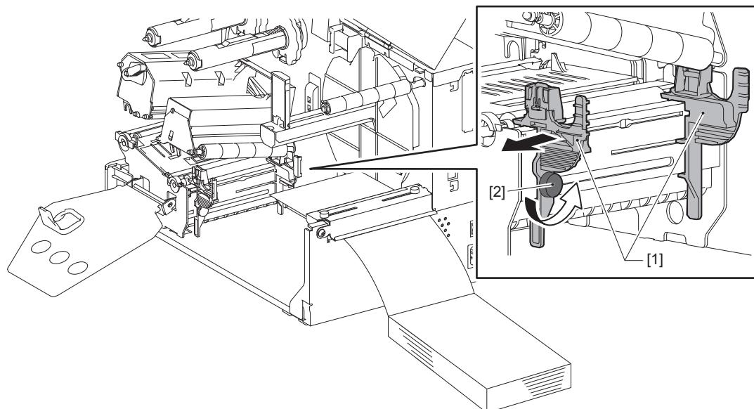
**9** 用紙 [1] の先端を左右の用紙ガイド [2] の間へ通し、印字ヘッド機構部の下側を通して用紙発行口まで送り出します。
