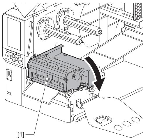
**14** リボンシャフト固定板 [1] をセットし、ヘッドレバー [2] を「LABEL2」位置に回して印字ヘッド機構部を固定します。
