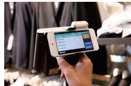
▲RFIDハンドリーダーUF-2200は、入荷検品や在庫管理の大幅な省力化に貢献している
