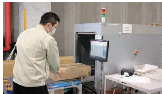
▲読み取り精度を高めるRFIDトンネル式ゲートで作業効率アップ
