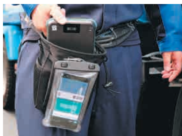
▲ハンドリーダーUF-3000の持ち手（オプション）を外し、ウェアラブルデバイスとして運用
