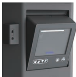
▲角度調整が可能なチルト機構のスキャナ
