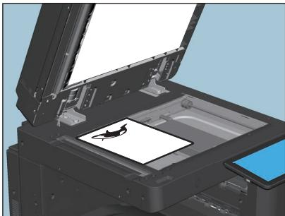
原稿面を上にして、原稿の下端を手前にし、左上のコーナーに突き当てるようにして置きます。原稿スケールのサイズ目盛りに合わせます。
