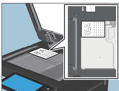
原稿ガラスの左奥コーナーに突き当てるよう置きます。コピーしたい面を下にして、原稿の上側を本機の左側に向けてください。
