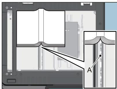
原稿ガラスの下にあるAの部分に冊子の中心を合わせてセットします。
