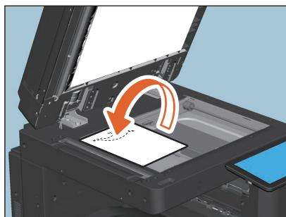
原稿面を下にして、原稿の下端を手前に向け、左上のコーナーに突き当てるようにして原稿ガラス上に置きます。原稿を横にセットした場合は、原稿の上端を原稿ガラスの左端に当てて置きます。
