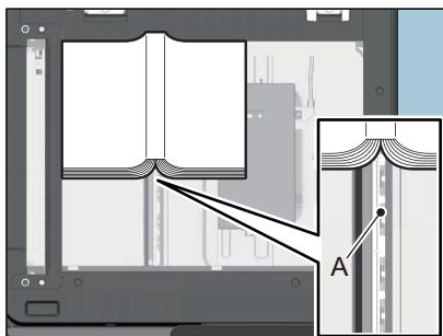
原稿ガラスの下にあるAの部分に冊子の中心を合わせてセットします。
