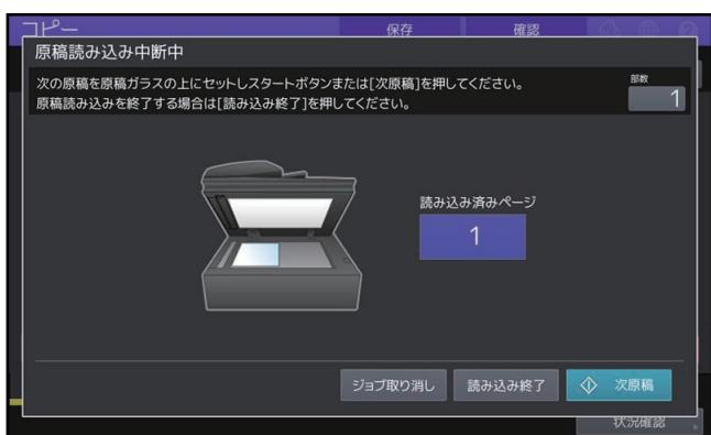
この画面は、原稿送りモードを「1枚送り」に設定している場合や、原稿ガラス上に原稿をセットして、ソートコピーや片面→両面コピーなどのように原稿をメモリに読み込んでからコピーしている場合に表示されます。この画面が表示されたら、以下の手順に従って操作してください。
