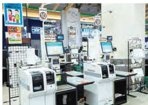
▲セルフレジはカメラ付きのSS-950を導入。正面のモニターにお客様の手元と正面映像が映し出され、防犯対策にも有効
