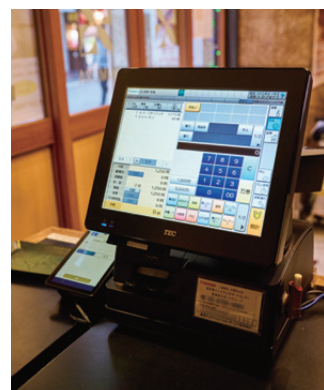
◀POSレジはタッチパネル式のQT-200を使用。狭いスペースにも設置でき、カラー画面が見やすいと好評だ
