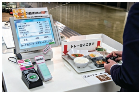
▲料理を載せたトレーを置く、レジ画面にメニューと金額、総カロリーが自動的に表示される。決済は社員証による給与引き落としのほか、Suicaなどの交通系ICカードに対応
