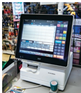
▲POSレジはタッチパネル式の「QT-200」を導入。ボタン配置を以前使っていたキーボード式のものに近づけるようカスタマイズして使用
