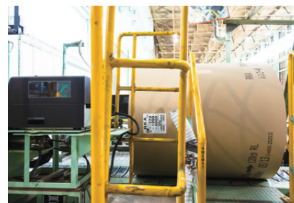
▲抄造後の外装用ライナに、ラベルプリンタで印刷した RFIDタグ(写真中央)をアームで貼付
